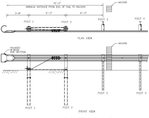
TYPE 31 GUARDRAIL - TRAILING END LENGTH OF NEED BEYOND HAZARD
